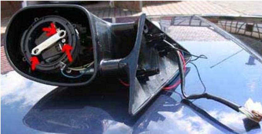
...drei Löcher für den neuen M3-Spiegel bohren und Spiegel montieren.
