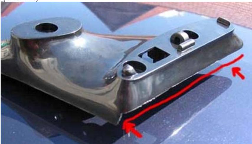
...den Originalmotor in den M3-Spiegel einbauen (nur 3 Schrauben, die Kabel bleiben vom Originalanschluss), Spiegelglas befestigen und die angepasste Adapterplatte festschrauben.
