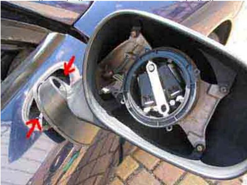
...die Adapterplatte an der unteren Kante passend abschleifen (ich hab´s mit Flex gemacht)
