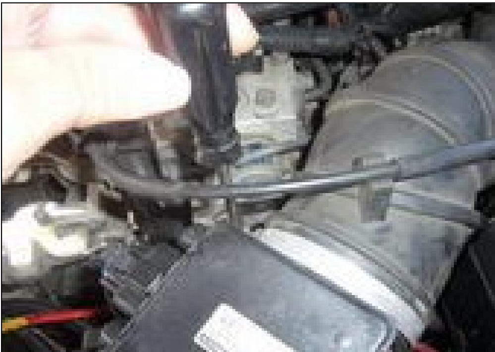
3.Den Ansaugschlauch (oder das air-intake-system) abschrauben.(bis Bild 8)
