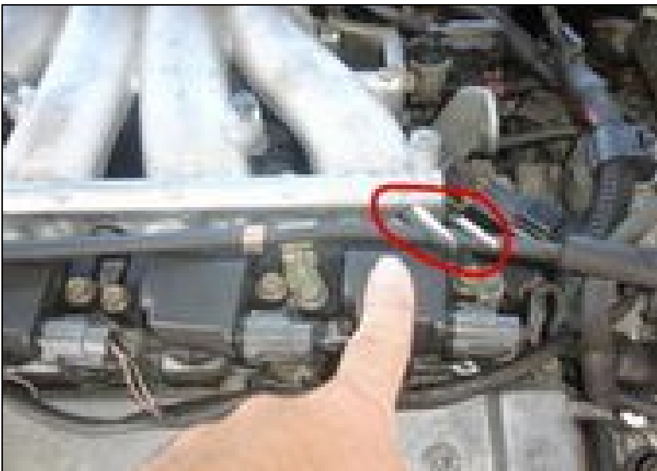
18. Auf der Gegenseite die Halter aufbeigen und Gaszug ausfädeln.
