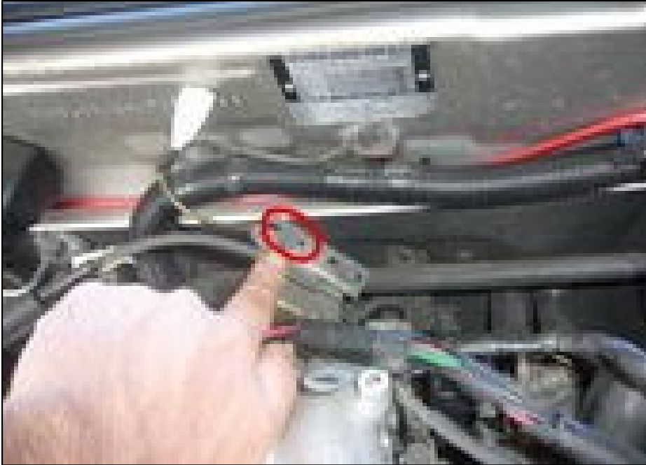
19. Massekabel des Gaszuges entfernen.
