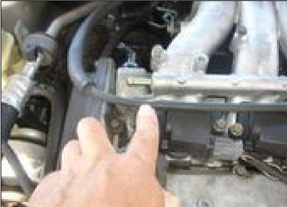
17. Gaszug rechts aus den Haltern klippsen, einfach ausfädeln.
