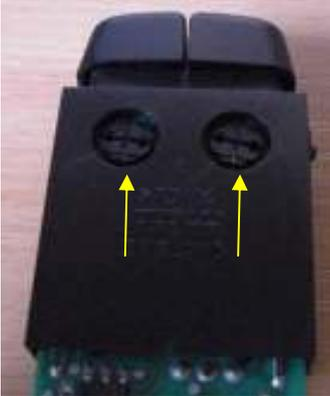
Dazu müssen die mit Pfeilen markierten Lampen entfernt werden. Leicht nach links drehen und rausziehen.
