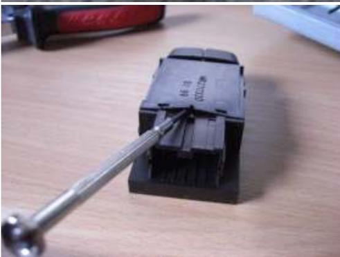
Bei den Pfeilen befinden sich Haltenase. Da diese sich nicht reindrücken lassen, muss man das Plastik wie auf dem Bild **VORSICHTIG** hochhebeln. Ich habe dazu einfach ein kleinen Schlitzschraubendreher zwischen geklemmt. An den Seiten habe ich mit einem zweiten Schraubendreher erst die eine und dann die andere Seite gelöst. Wenn alles Gelöst ist, kann man den Schalter einfach auseinander ziehen.
