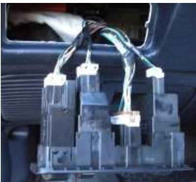
Die Schaltereinheit wieder einsetzen, Stecker ran stecken und die Schalterblende wieder ins Armaturenbrett drücken.
