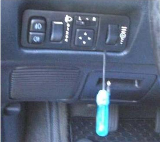
Als erstes die Schalerverkleidung aus dem Armaturenbrett entfernen. Wenn man **VORSICHTIG** ist kann man es, so wie ich, mit einem Schraubendreher machen. Aber ich Rate davon ab, da man mit einem Schraubendreher leicht Kratzer in Kunststoffteile macht.
